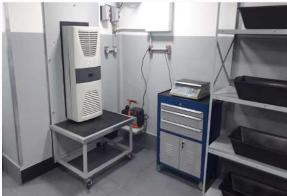
Nesta cabine produzimos a carga térmica simulando um armário elétrico.
